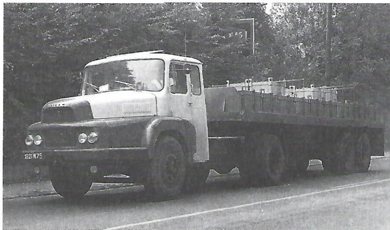
Tracteur de 35 t de PTR haut de gamme, l'Izoard MZ 221 T avait bien des atouts avec son V-8 de 225 ch.
