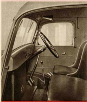
Cabine spacieuse, 3 types places, rembourrées, bien suspendues grâce aux amortisseurs AV hydrauliques, siège du conducteur réglable.
