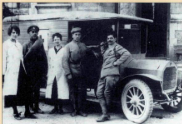
**Oben:** Leichter Lkw mit Plane auf dem Fahrgestell „C 9 Serie L 4“ mit 35-PS-Motor aus dem Jahr 1914.
