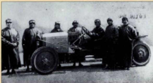
Motor mit einteiligem Motorblock und 2.626 cm<sup>3</sup> Hubraum, 4-Ganggetriebe plus Rückwärtsgang, Kardanwellenantrieb, Rechtslenkung, Radstand 2750 bzw. 3200 mm und einer Gesamttragkraft (einschließlich Aufbau) von 1,4 bzw. 2,2 Tonnen.
