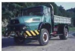
1967 la nouvelle generation Izoard V8 avec 270 ch et Injection Saurer
