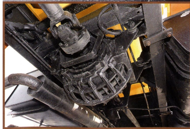
Anker für den Tanker: Die serienmäßige Wirbelstrombremse sorgt für vernünftige Verzögerung bergab
